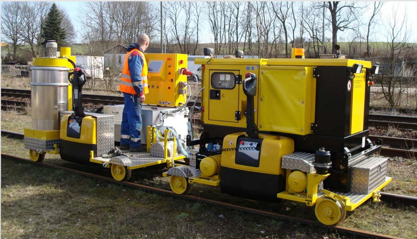
Bei der LRGM 1-2/ AM 16 handelt es sich um ein Schleifgerät, das zur Bearbeitung der Schienenoberfläche mit Hilfe eines angehängten Stromerzeugers betrieben wird. Auf diese Weise sind keine Stromversorgungskabel in der Baustelle notwendig. Das Schleifgerät lässt sich je nach Bedarf per Rampe von einem Schienenfahrzeug oder per Kran in der jeweiligen Baustelle ein- und ausgleisen.
