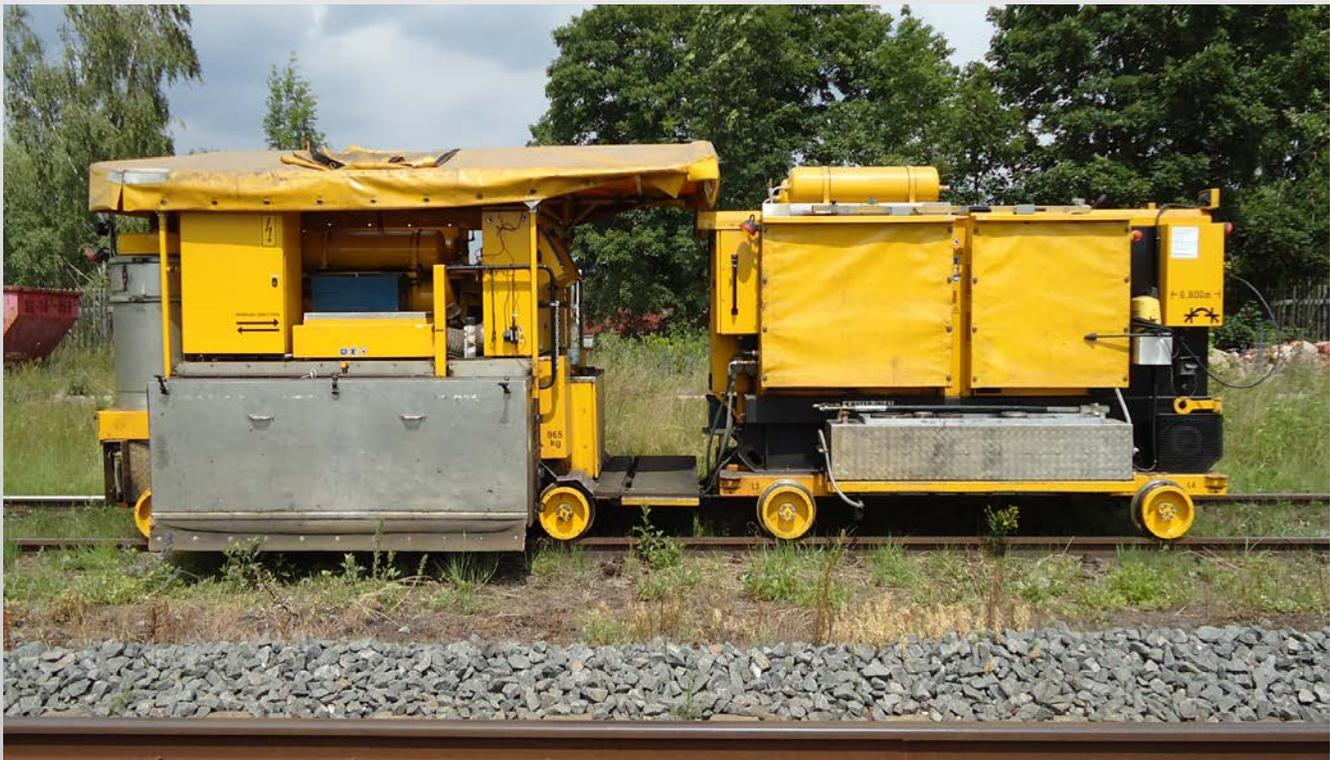
Bei der LRGM 1-6/ AM 65 handelt es sich um ein Schleifgerät, das zur Bearbeitung der Schienenoberfläche mit Hilfe eines angehängten Stromerzeugers betrieben wird. Auf diese Weise sind keine Stromversorgungskabel entlang der Einsatzstelle notwendig. Das Schleifgerät lässt sich je nach Bedarf per Rampe von einem Schienenfahrzeug oder per Kran in der jeweiligen Baustelle ein- und ausgleisen.
